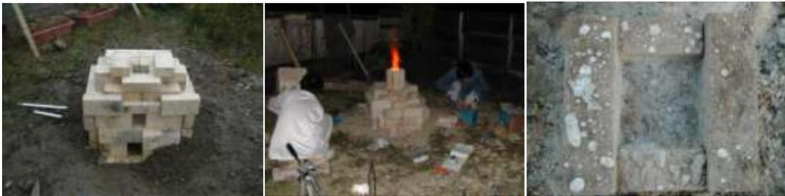
図 14:リサイクルガラスを使った熔解実験。プール真上の最高温度は 930℃までしか達成できなかったが、ガラスは液状化した。レンガにこぼれたガラス屑が熔けてブルジュ・アル・シャマリ出土ガラスのような形になっていた。これは原料からガラスを作るのではなく、リサイクルガラスを使って熔かしていた可能性を示唆している。
