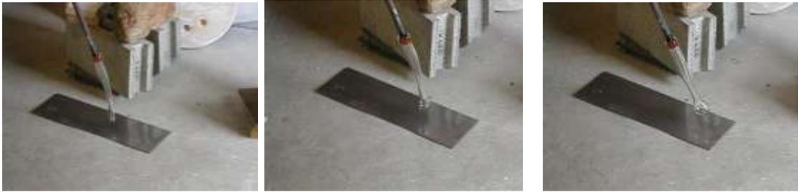
図 3: ガラスを一気に伸ばした後、すぐに息を入れた時の連続写真。竿を下に向けるとガラスは伸びて薄くなり、冷え固まるが先端はガラスの厚みがある分まだ軟らかいので膨らむ。その結果、内側に湾曲した頸部となる。写真左から右までの間はわずか 8 秒ほど
